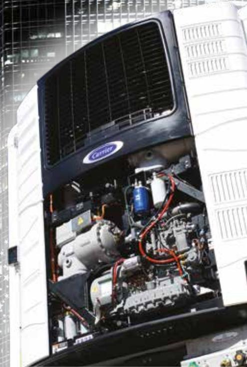
Le groupe pour semi-remorques fonctionnant au réfrigérant naturel utilise exclusivement du dioxyde de carbone (CO<sub>2</sub>) comme réfrigérant au sein d'un système en circuit fermé. Le CO<sub>2</sub> est un gaz sans danger qui ne participe pas à l'appauvrissement de la couche d'ozone avec un Potentiel de Réchauffement Global (PRG) de 1, ce qui en fait la référence face aux autres réfrigérants évalués sur ce même indicateur.
