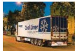
La semi-remorque Cool Liner bénéficie, pour le marché français de la distribution, de nouveaux amortisseurs renforcés de mise à quai dotés de 4 rouleaux. De plus, la nouvelle cloison multi-température en une seule partie est plus légère. Elle est dotée
