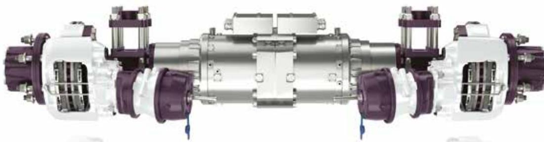
*eTransport : BPW propose pour les VUL à propulsion, un essieu doté, non pas d'un mais de 2 moteurs électriques, chacun relié à une roue.*
