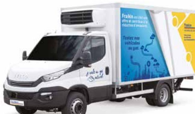
*Ce démonstrateur est carrossé par Cazaux. Il est équipé du groupe électrique avec génératrice mono-température Carrier Pulsor 400.*
