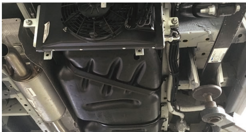
Condenseur sous véhicule.
