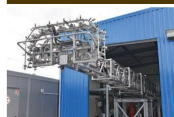
Une fois le véhicule en position, le robot dont la base est solidement fixée à son socle, s'introduit dans la carrosserie en se dépliant à l'horizontale.
