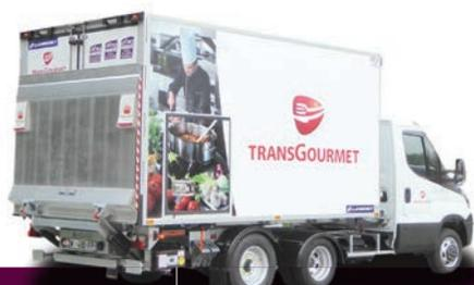
**F**rigomax, c'est l'utilitaire frigo ultra-compacte qui charge 3 fois plus que les autres ! Il se compose d'un utilitaire 3,5t équipé de l'attelage Maxicargo et d'une remorque 3,5t de type Maxicargo, guidée par le véhicule et carrossée avec une caisse frigo. Le tout forme un ensemble compact et facile à conduire avec le permis BE (voiture + remorque). « Au SELFI, sur le circuit de Monthléry, le Frigomax a fait l'unanimité », affirme Jean-Phi-
