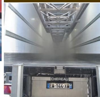
La tête du robot est équipée de buses rotatives qui projettent l'eau sous haute pression. La consommation d'eau est de 500 litres. En deux passages (haut et bas) dans la carrosserie.
