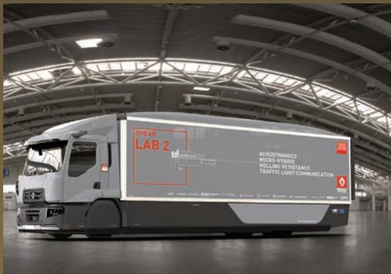
Urban Lab 2, véhicule laboratoire de distribution, est développé dans le cadre du projet collaboratif EDIT (Efficient Distribution Truck) avec six partenaires. Il rassemble des technologies innovantes liées à l'aérodynamique, à l'hybridation du moteur, aux pneumatiques ou encore à la communication véhicule-infrastructures pour, au final, parvenir à réduire la consommation de 13 %.
