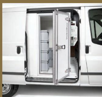
Ce conteneur frigorifique amovible transporte de -18°C jusqu'à 25°C. Le caisson utilise l'alimentation du véhicule ou une source de courant externe. Principale innovation : le groupe compresseur est amovible pour plus d'aspects pratiques.
