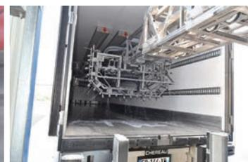
Le robot pulvérise 38 litres d'eau additionnée de biocide pour une sanitation parfaite.
