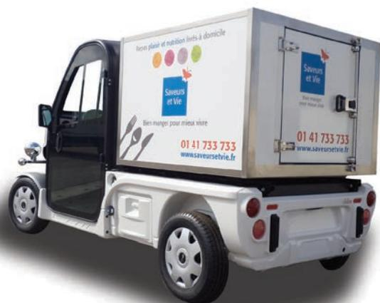
**D'un volume pouvant aller jusqu'à 2 m<sup>3</sup>, ces véhicules répondent aux contraintes physiques et logistiques les plus exigeantes de la chaîne du froid. Aussi simplement que l'on recharge le véhicule électrique, le container Alcatherm 2 de Coldway se branche parallèlement sur secteur et retrouve sa capacité à produire du froid de manière autonome en quelques heures.**
