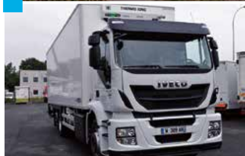
Iveco GNV avec solution CryoTech de Thermo King pour des livraisons propres.
