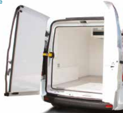
La solution groupe froid totalement intégré apporte une réponse aux attentes spécifiques (accès parking, tarif de péage autoroutier en classe 1, lavage VP à rouleaux).
