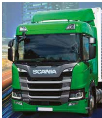
Comparée à celle qu'elle remplace, la nouvelle cabine CG20N « à toit normal » offre 10 cm de hauteur intérieure supplémentaire.
