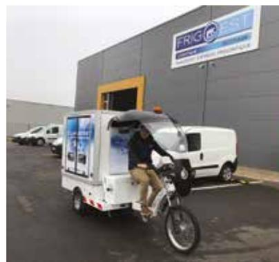
Autolimité à 15 km/h, le véhicule embarque 1,6 m<sup>3</sup> et 250 kg de charge utile, soit 12 caisses de livraison de 600x400x300, en FRA ou FRC.
