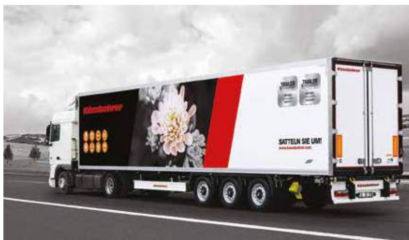
Le châssis de K.SRI F, en acier haute résistance, est garanti 10 ans contre la rouille.
