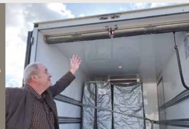
RK Com fabrique le rideau d'air RKair adapté à toutes les carrosseries isothermes quasiment au même prix que des lanières.
