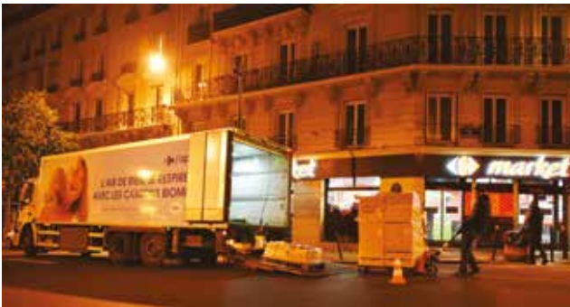
Paris, 6h00, rue de Maubeuge. Exploité par Perrenot, ce porteur Iveco GNV est équipé du groupe Frappa Silencio cryogénique à l'azote liquide.
