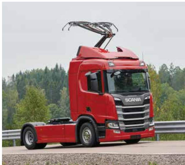
Poids lourd Scania équipé pour rouler sur une « route électrique » avec caténares.
