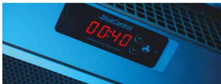
Le module BlueControl propose aux conducteurs d'avoir une visibilité de la durée d'ouverture des portes sur un écran numérique.
