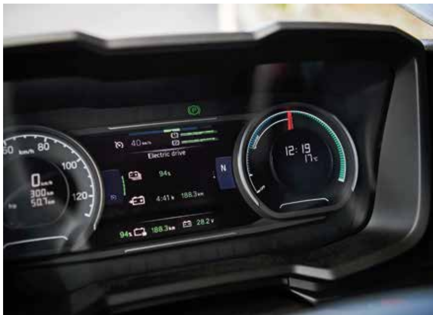
Dans un camion électrique, le compte-tours est remplacé par un indicateur de consommation ou de récupération d'énergie.
