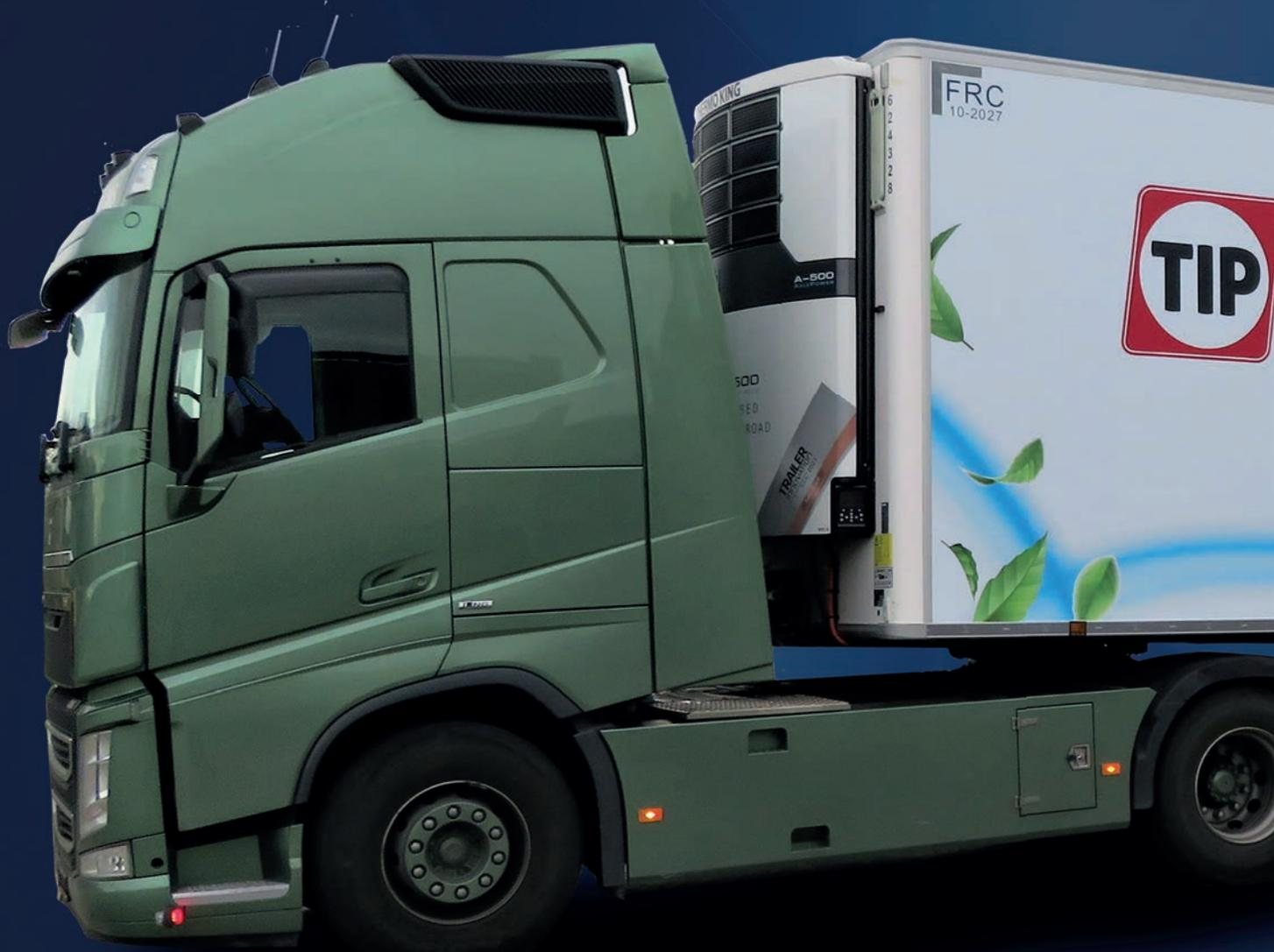
Ouvrant la voie pour des semi-remorques frigorifiques sans émissions, le projet est le fruit d'une collaboration entre TIP GROUP, Thermo King et BPW. Développé en partenariat avec BPW, l'Advancer AxlePower de Thermo King est un système entièrement intégré et indépendant du véhicule-tracteur qui combine l'essieu ePower de BPW avec le groupe frigorifique et la technologie de stockage par batterie de Thermo King. Les semi-remorques
