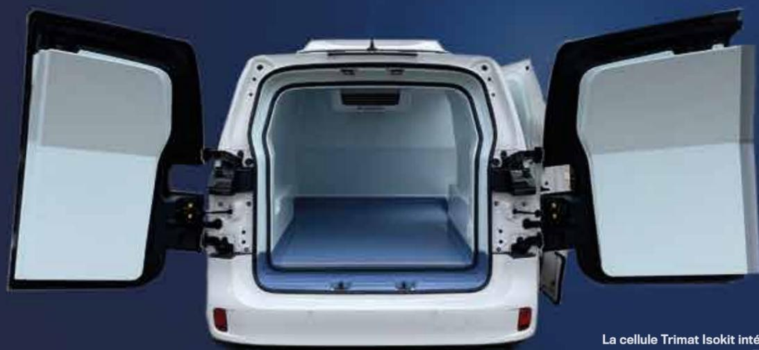
La cellule Trimat Isokit intégrée est réalisée en matériaux composite. Elle génère un surpoids de 150 kg.
