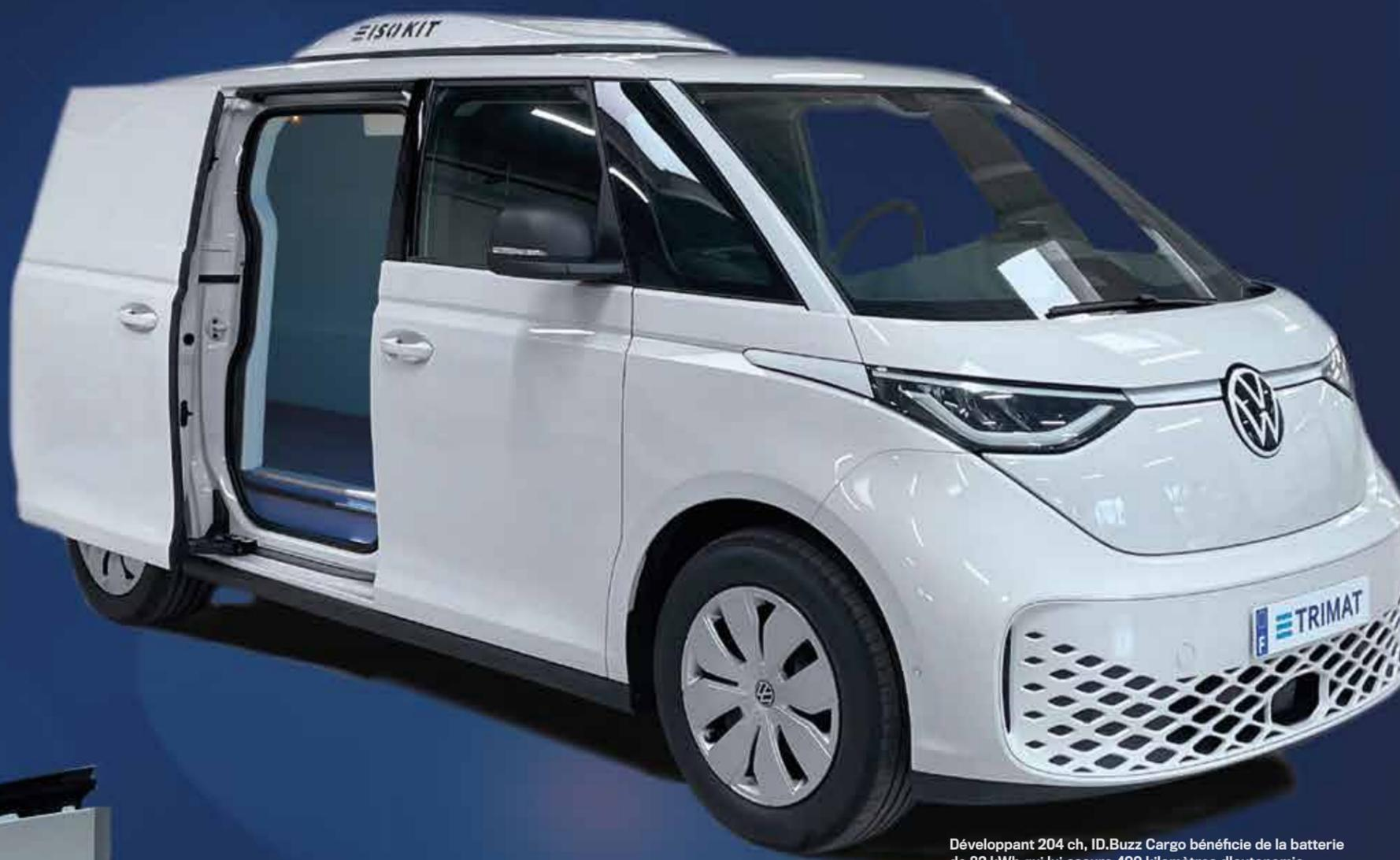
Développant 204 ch, ID.Buzz Cargo bénéficie de la batterie de 82 kWh qui lui assure 400 kilomètres d'autonomie.
