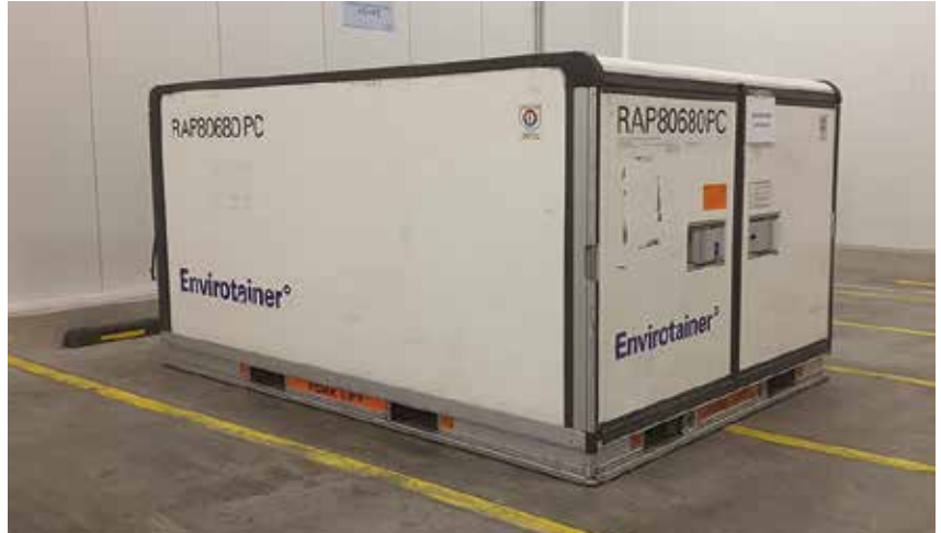
Conteneur aérien isotherme actif Envirotainer utilisé par Bolloré Logistics pour le transport de produits « pharma »
