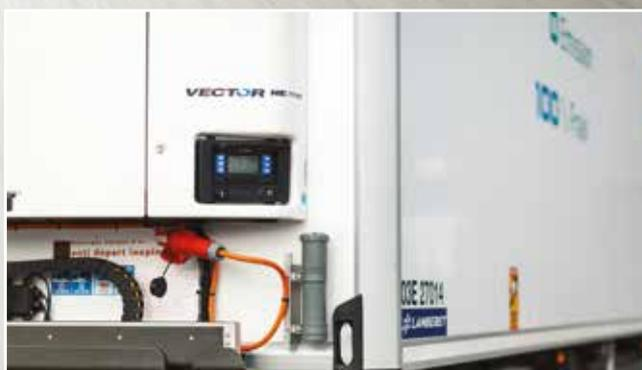
Le groupe frigorifique CARRIER peut-être 100% électrique ou hybride, et la puissance délivrée par la pile à combustible permet un fonctionnement en multi-température.
