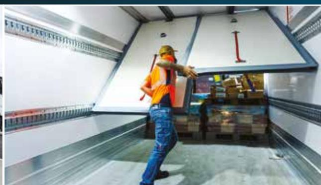
Équipée d'un rideau automatique Distri+ et des cloisons Ergowall, SR2 FRESH2 permet une exploitation sûre et efficace en multi-température, conforme au cahier des charges fixé par STEF.
