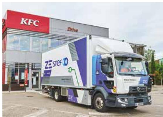
Ce porteur électrique est équipé en sous-châssis de l'unité de réfrigération Carrier Iceland sans moteur thermique.
