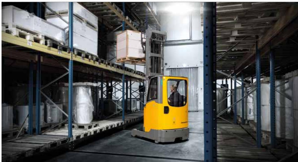
Pour réduire les risques liés à la conduite de chariots en atmosphère froide, ils doivent posséder une cabine fermée et chauffée.
