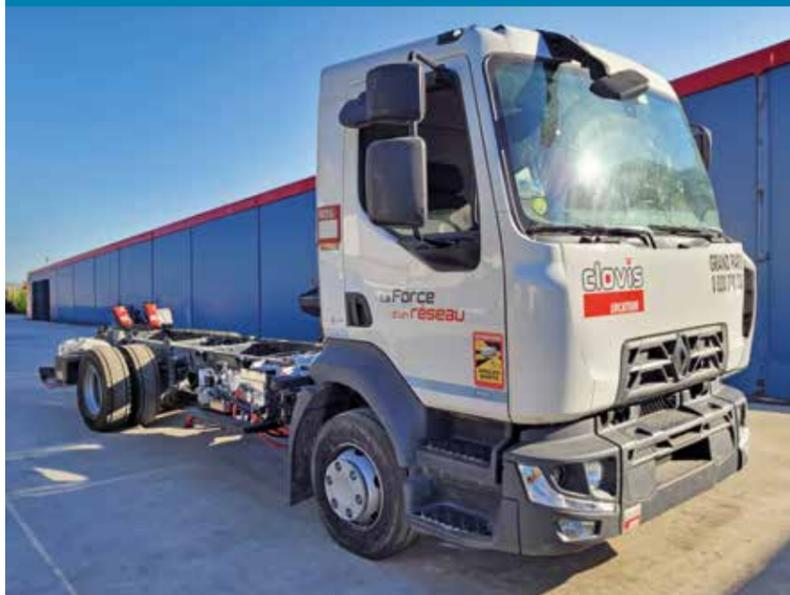
Ce Renault D210 de 12 t a troqué son moteur diesel DT15 contre une chaîne cinématique électrique dans le cadre d'un rétrofit réalisé en collaboration par Renault Trucks, Novumtech et l'Ademe.
