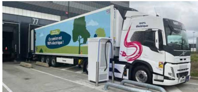
Le froid « électrique » est produit par Carrier dans cette semi-remorque Krone attelée au tracteur Volvo FM Electrique opéré par Bert&You pour Lidl.
