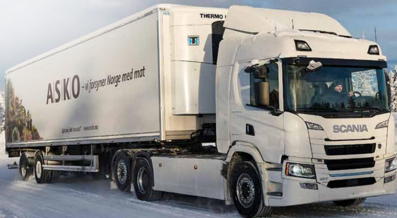
Ce tracteur Scania 25P 6x2 à empattement long fait la démonstration de la possibilité d'exploiter un BEV avec une semi-remorque frigorifique même en conditions climatiques extrêmes.
