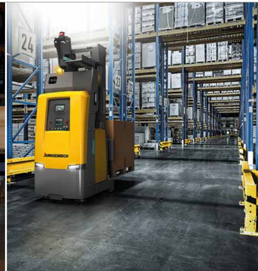
EKS 215a est un AGV capable de stocker des charges de 700 kilogrammes à une hauteur pouvant atteindre six mètres.
