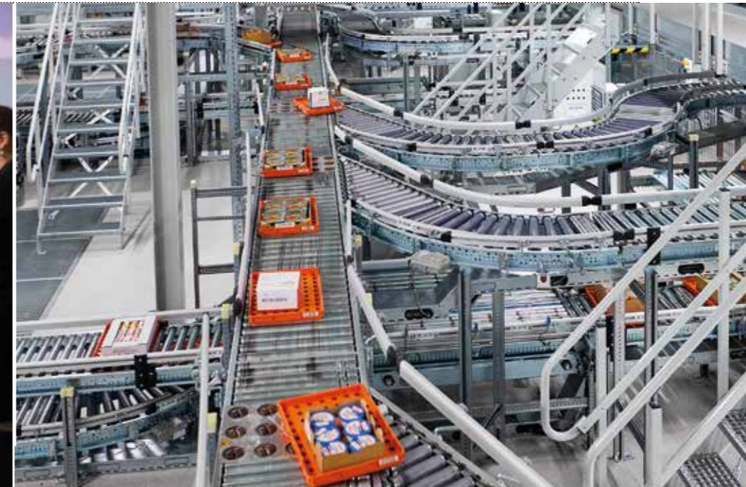
Le système automatisé FPM peut préparer jusqu'à 172 000 commandes par jour.
