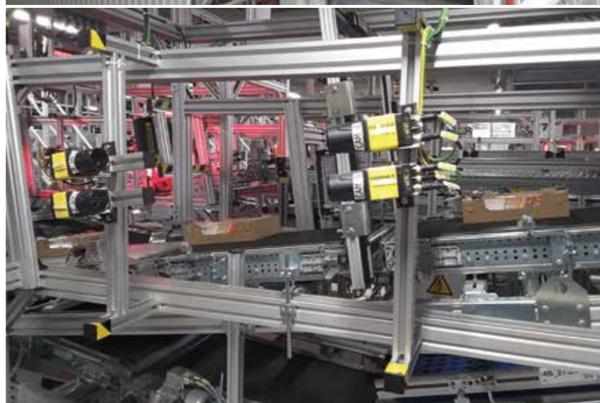
Le système FPM de Scapalsace est équipé de 14 tunnels de lecture vidéo.
