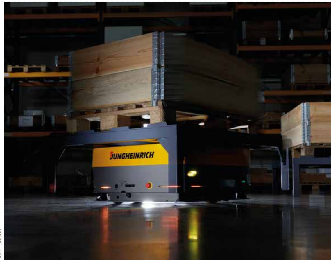
L'arculee S est un AMR conçu pour le transport horizontal dans des zones définies.
