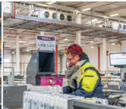
Alimenté par 12 postes manuels, injectant jusqu'à 8 400 colis par heure, un trieur prépare les commandes de produits frais des magasins Netto et Intermarché.
