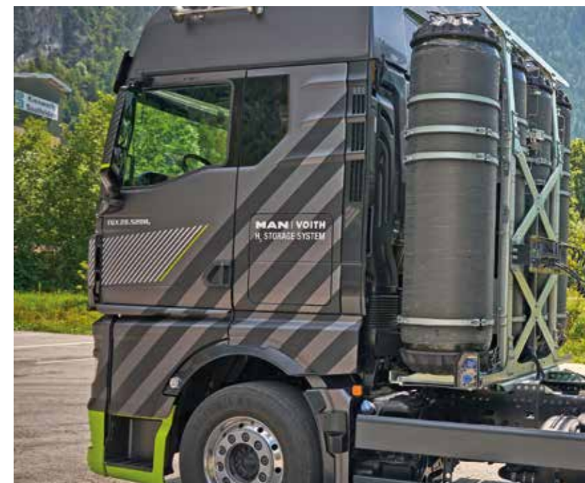
Développés par Voith, les réservoirs d'hydrogène compressé sont les organes les plus onéreux du véhicule. Ils nécessitent un savoir-faire spécifique.
