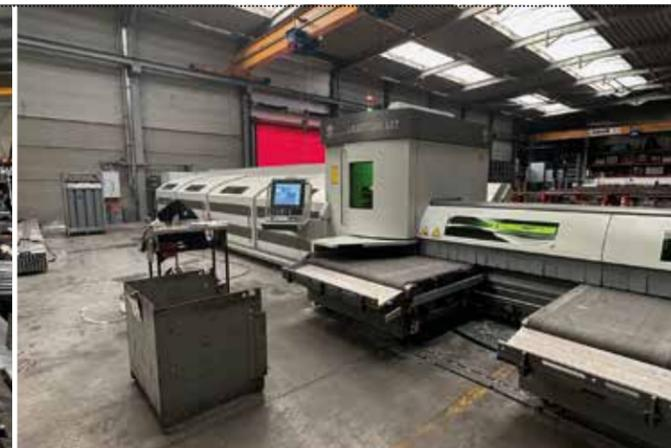
Récemment intégrées dans le procédé d'usinage, les machines « Laser Tube » permettent d'alléger le travail d'assemblage des opérateurs mécano-soudeurs.
