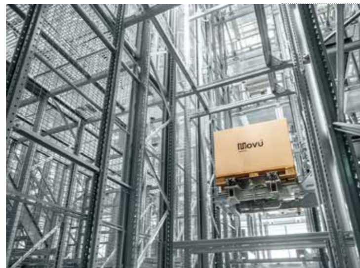
Le système à navettes pour palettes Movu atlas peut fonctionner de manière optimale dans des températures allant de -25°C à 40°C.
