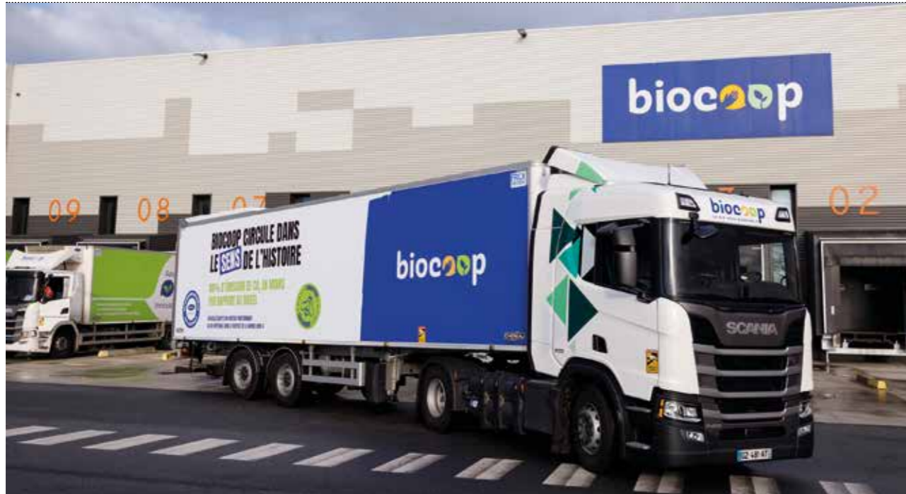
La semi-remorque Chéreau est remorquée par un tracteur Scania de 420 ch fonctionnant au biogaz.
