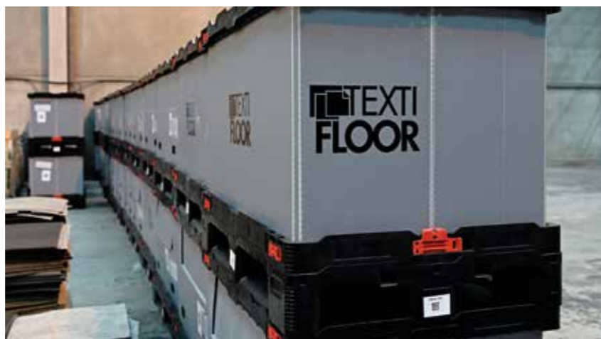
Les box-palettes Smart-Sleeve-Pack ont une capacité de charge de 400 kg par unité.
