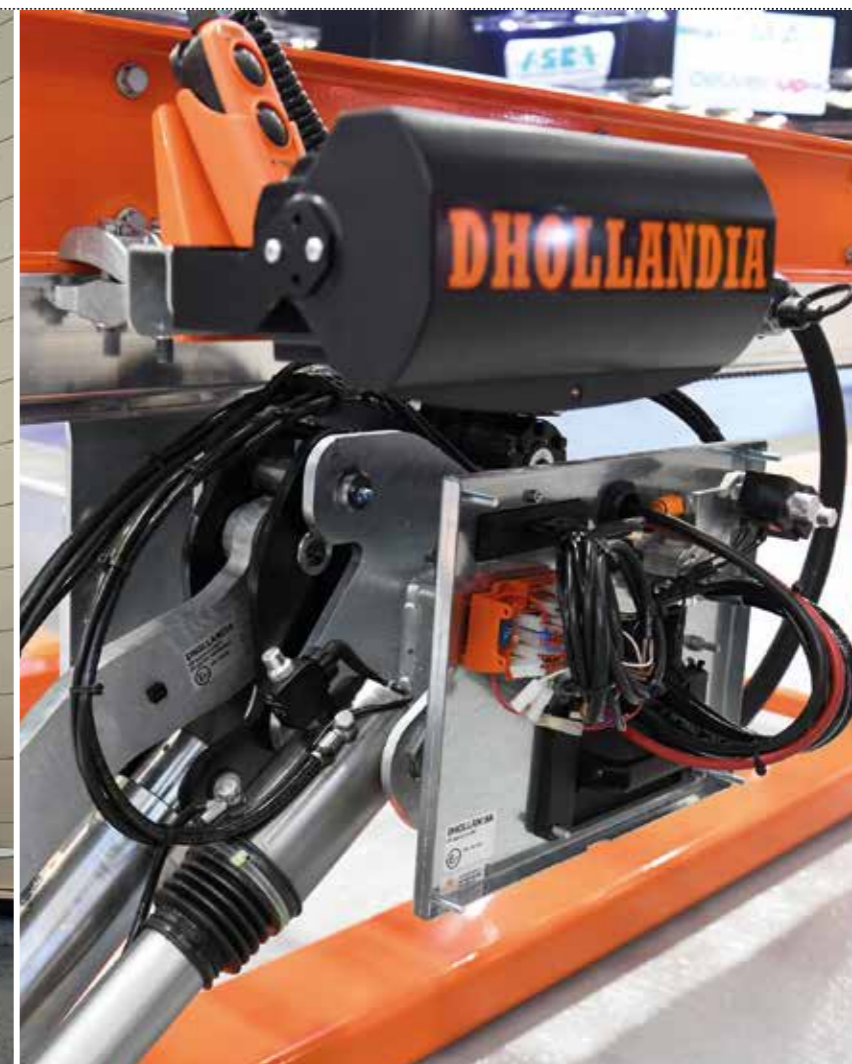
Le produit évolue fréquemment. L'insertion du groupe dans la poutre est l'une de ces évolutions. Les hayons Dhollandia fonctionnent sans électronique.
