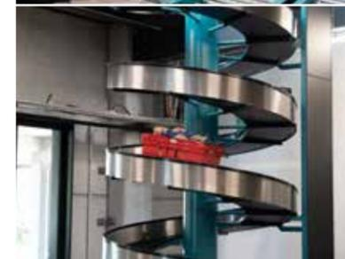
Convoyeur en colimaçon au-dessus des stations de livraison.
