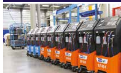
Conservant leurs propriétés fonctionnelles, les réfrigérants recyclés par les centrales ECOCLIM RF404 et RF452 sont réinjectés dans les groupes.
