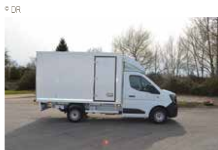
La caisse Isobox est équipée de série d'une ouverture arrière totale de battant, de plinthes aluminium 3 faces, marche-pied arrière escamotable, éclairage LED.
