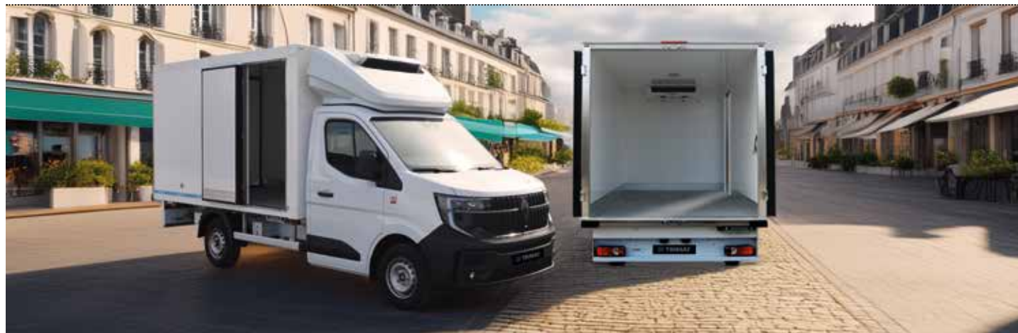
La caisse Isobox reçoit un très bon accueil du marché avec ses étagères réglables et relevables, son plancher intermédiaire (zone arrière seule ou arrière + avant), seuil marée, lisse de protection aluminium, rails d'arrimage, sangle d'arrimage.
