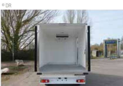
Certification ATP « isotherme renforcé » (Cemafrond N°D14/001) avec ou sans porte latérale, constituée d'un système étanche de panneaux composites moulés monoblocs de technologie et fabrication Trimat.
