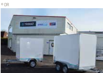
De série sur la remorque Isotrail : groupe froid électrique Rivacold ou Govi (rallonge 5 m), panneaux de 60 mm d'épaisseur, ouverture à 1 battant (1430 mm X 830 mm) et plancher intérieur antidérapant isolé (épaisseur 23 mm).
