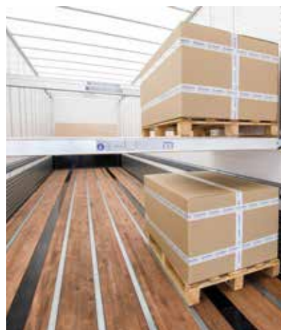
Xtradeck double la capacité des palettes dans une semi-remorque.
